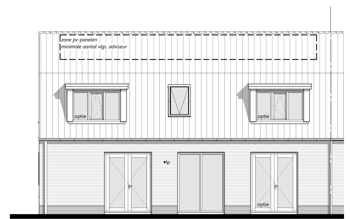
achtergevel 1 : 100 optie: dubbele deuren achtergevel optie: dakkapellen (2x) achtergevel optie: extra zonnepanelen; aantal vlgs. opgave aanbieder
