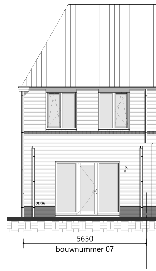
achtergevel 1 : 100 optie: uitbouw 1200mm optie: uitbouw 2400mm
