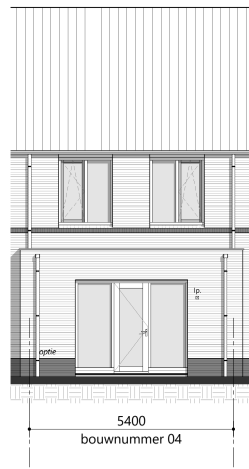
achtergevel 1 : 100 optie: uitbouw 1200mm optie: uitbouw 2400mm
