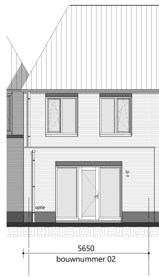
achtergevel 1 : 100 optie: uitbouw 1200mm optie: uitbouw 2400mm
